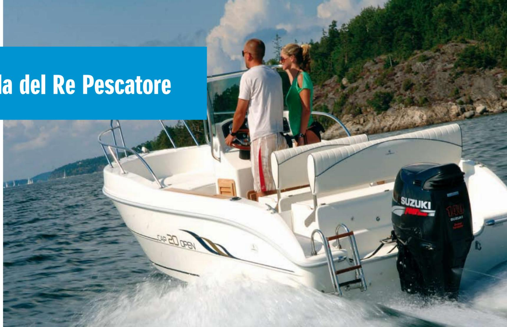
Il DF140 è caratterizzato da un doppio albero a camme in testa con quattro valvole per cilindro, un collettore di aspirazione raffreddato ad acqua, un sistema di scarico 4-2-1, l'iniezione elettronica multipoint digitale sequenziale, un sistema di alimentazione raffreddato ad acqua e una presa d'aria più ampia per aumentare ancora di più potenza e prestazioni.
